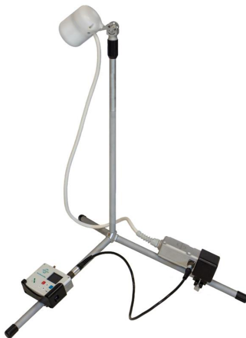
Рисунок 11 – Датчик CSmag и пульт, закреплённые на немагнитной треноге
