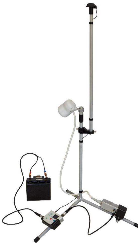
Рисунок 1 – Магнитовариационная станция SmartQuantumMag с внешней ГНСС антенной и подключенным АКБ
