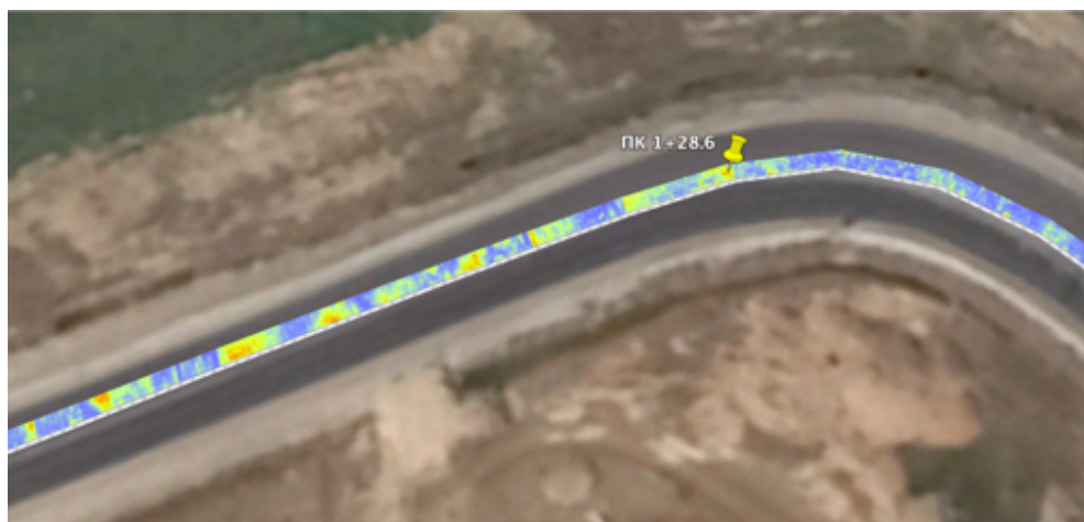
Рис.8 Вариант представления результата, как наложение амплитудной карты на спутниковый снимок с геопространственной привязкой по RTK GNSS
