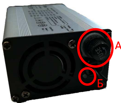
Рис. 1 — Зарядное устройство. А — Расположение предохранителей; Б — светодиодный индикатор
