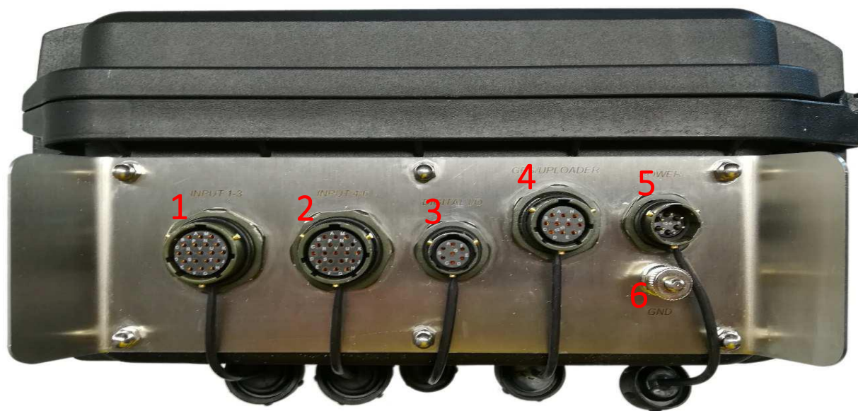
Рис. 5— Панель с разъёмами на правой стороне регистратора
