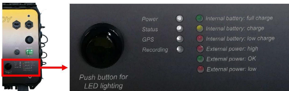
Рис. 3 — Часть передней панели регистратора с расположенными на ней светодиодными индикаторами
