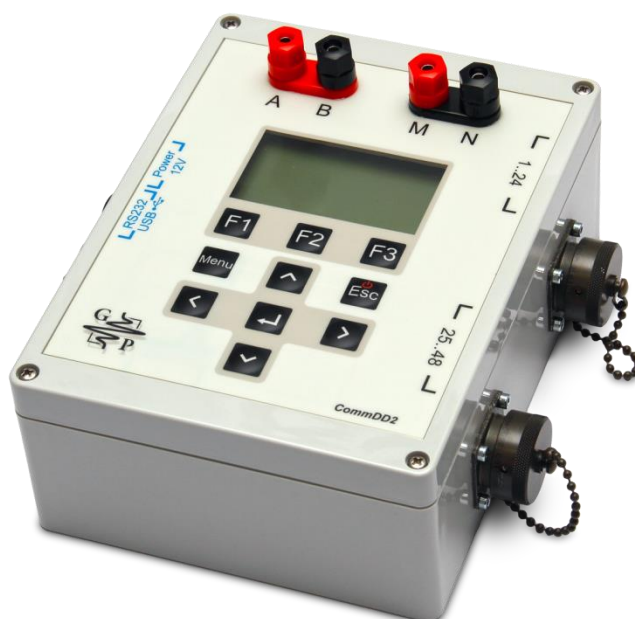
Рис. 2. Правая боковая панель коммутатора
