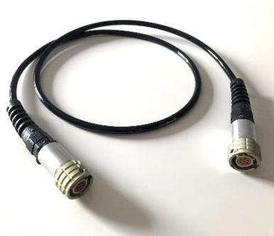
*Рисунок 12 – Кабель связи пульт-магнитометр*
