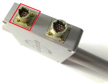
*Рисунок 9 – Разъём для подключения аккумулятора на корпусе магнитометра*
