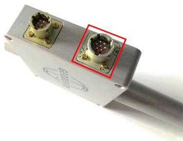
*Рисунок 7 – Разъём для подключения кабеля связи на корпусе магнитометра*
