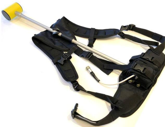
*Рисунок 6 – Магнитометр и аккумулятор в разгрузочном жилете*
