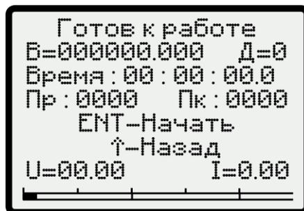
Рисунок 22 – Окно готовности магнитометра к измерениям в ручном режиме
