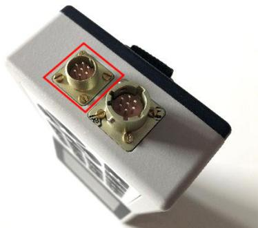
Рисунок 42 – Разъем для подключения кабеля USB на корпусе ПУ
