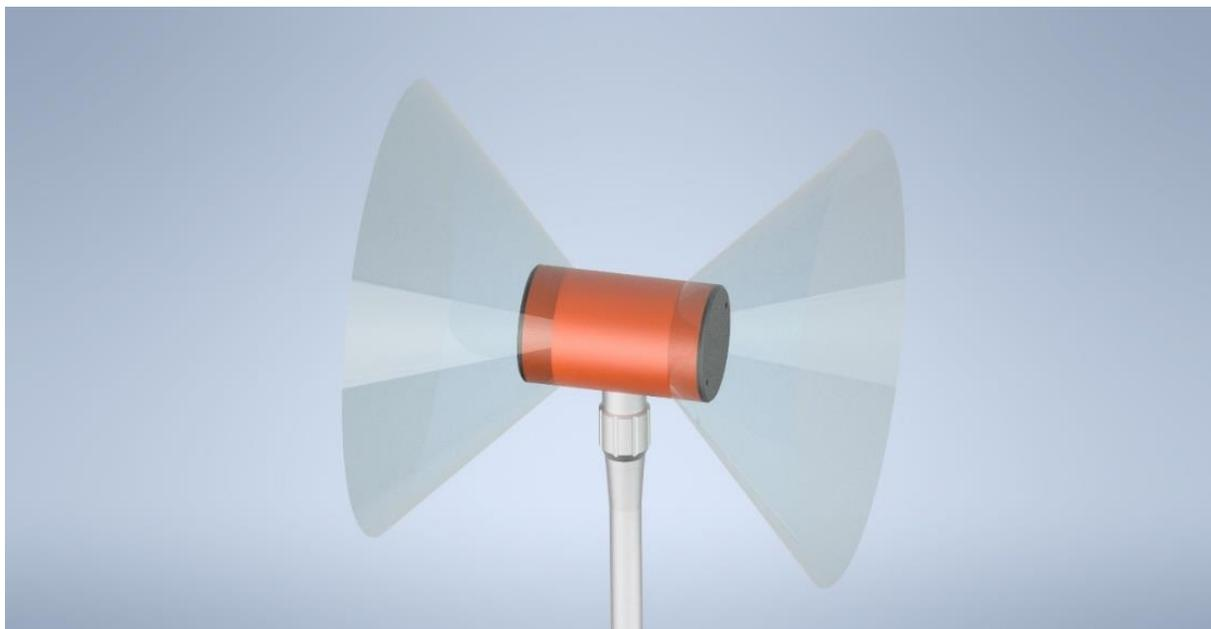
Рисунок 16 – Визуализация рабочей зона датчика магнитометра MiniMag.
