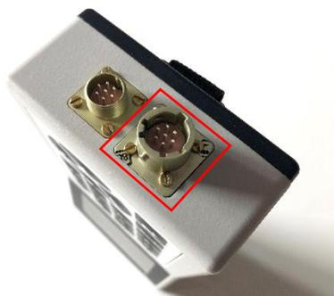
*Рисунок 11 – Разъём для подключения соединительного кабеля на корпусе ПУ*
