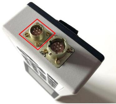
Рисунок 13 – Разъём для подключения кабеля с кнопкой дистанционного пуска на корпусе ПУ
