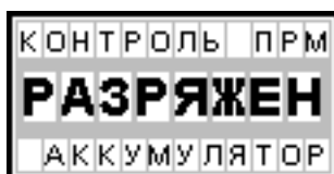
Рисунок 32 Отображение на дисплее разряженного состояния аккумулятора.
