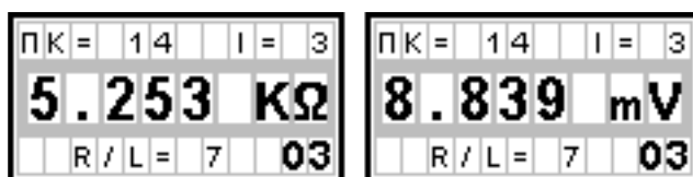
Рисунок 26 Примеры отображения на дисплее результатов измерения в режиме работы "Зондирование".
