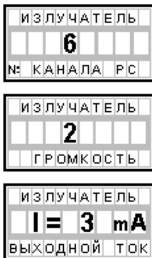
Рисунок 45 Примеры отображения параметров излучателя на дисплее.
