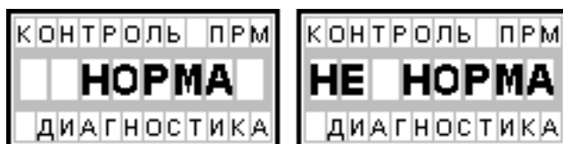
Рисунок 34 Два возможных результата экспресс диагностики приемника.
