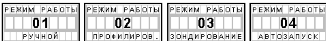
Рисунок 9 Отображение на дисплее возможных вариантов рабочих режимов.
