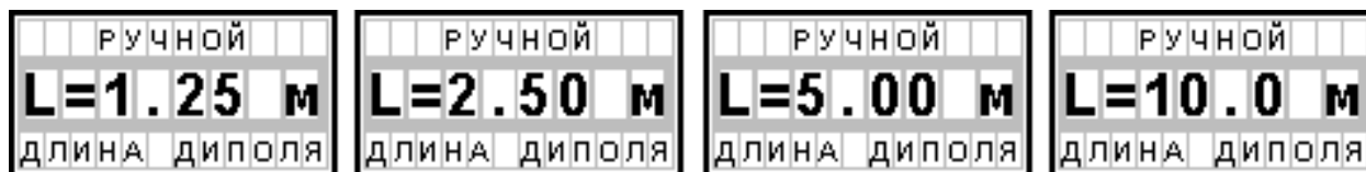
Рисунок 12 Примеры отображения на дисплее значения параметра «Длина диполя».
