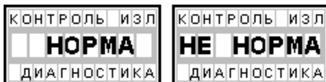
Рисунок 39 Два возможных результата экспресс-диагностики приемника.
