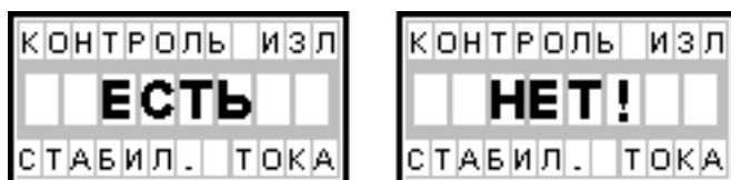
Рисунок 37 Варианты отображения информации о стабильности выходного тока излучателя.
