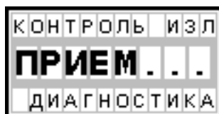
Рисунок 38 Отображение на дисплее ожидания результата самодиагностики излучателя.
