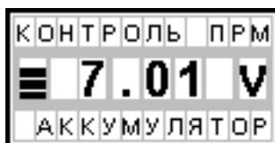
Рисунок 31 Контроль состояния аккумулятора приемника.
