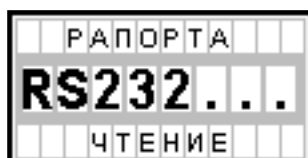
Рисунок 53 Отображение на дисплее инструкции чтения рапортов.
