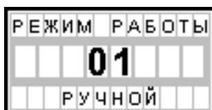
Рисунок 8 Отображение на дисплее режима работы «Ручной».
