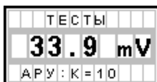
Рисунок 58 Отображение на дисплее тестового режима АРУ.
