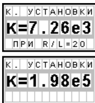
Рисунок 23 Примеры отображения на дисплее значения коэффициента измерительной установки.
