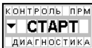
Рисунок 33 Отображение на дисплее пункта меню экспресс диагностики приемника.
