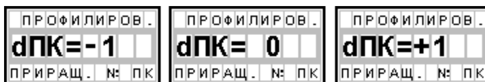
Рисунок 17 Примеры отображения на дисплее значения параметра «Приращение номера пикета»
