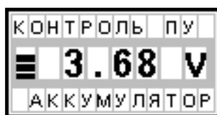
Рисунок 40 Контроль состояния аккумулятора пульта управления.
