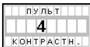
Рисунок 48 Регулировка контрастности дисплея пульта управления.
