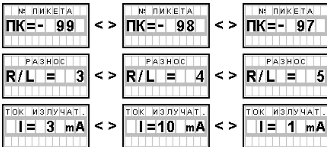
Рисунок 24 Примеры отображения на дисплее корректируемых параметров ручного режима работы
