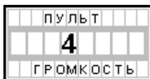
Рисунок 46 Регулировка громкости звукового сигнала пульта управления.
