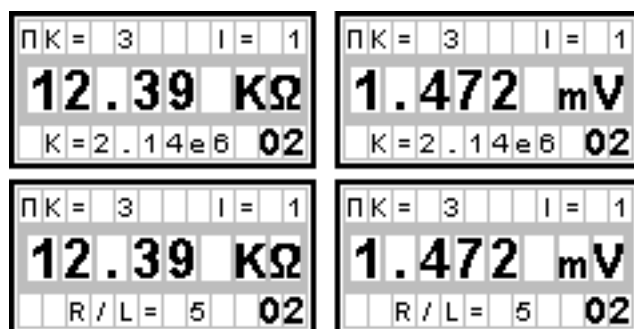
Рисунок 25 Примеры отображения на дисплее результатов измерения в режиме работы "Профилирование"
