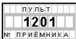
Рисунок 50 Отображение на дисплее номера блока приемника.
