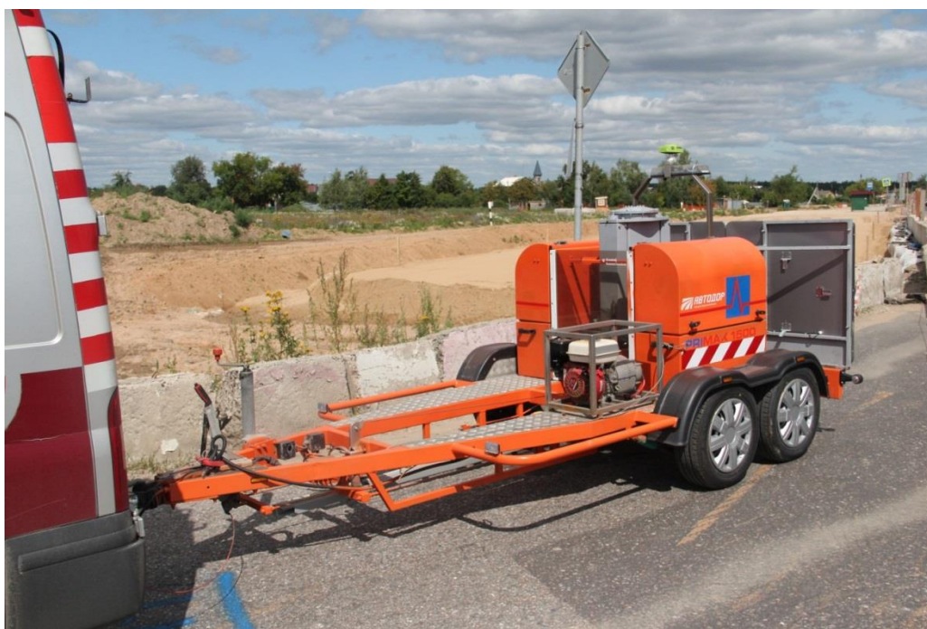
Рисунок 11 — Установка ударного нагружения Sweco (Grontmij) PRIMAX 1500 с установленной спутниковой аппаратурой
