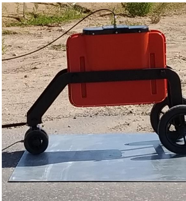
Рисунок 19 — Калибровка георадара над металлическим листом
