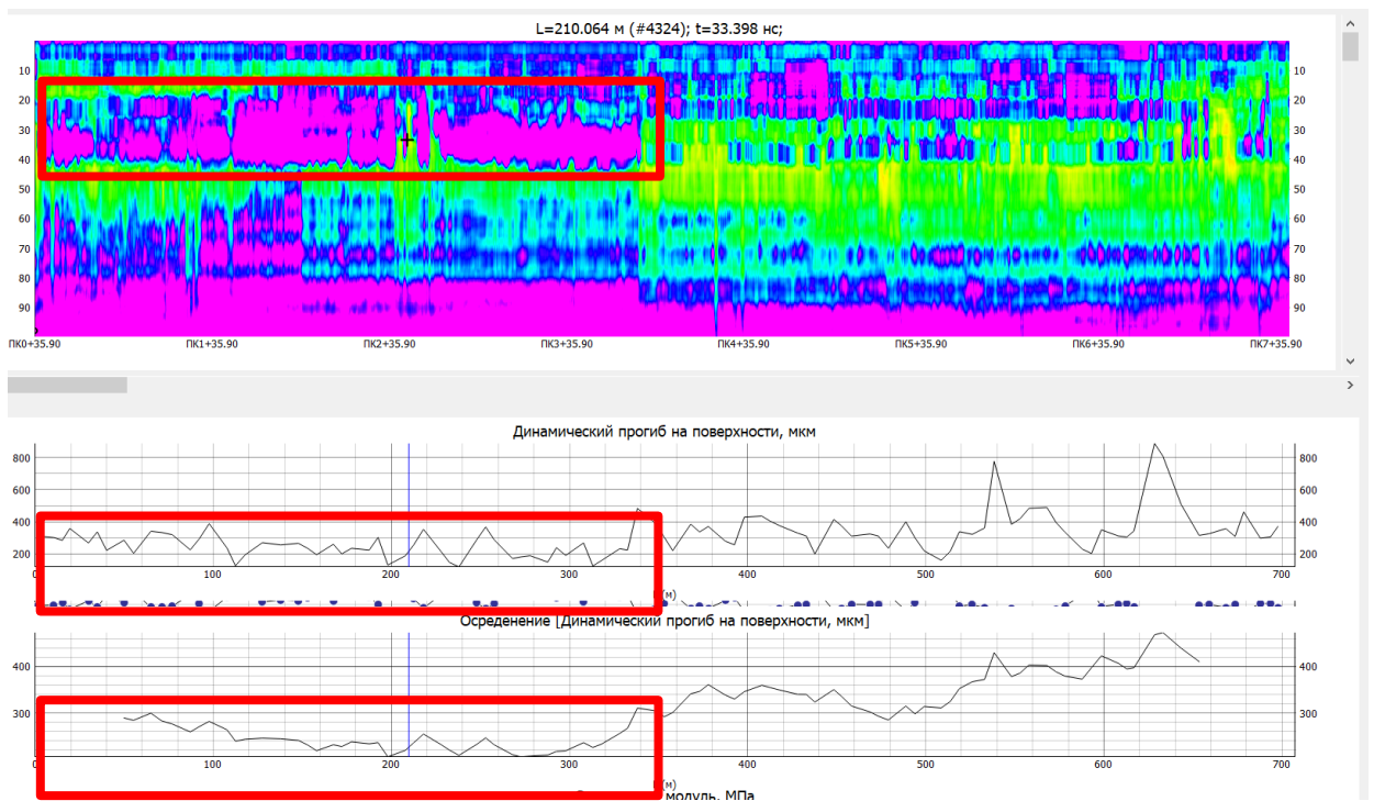
Рисунок 22 — Синхронное отображение радарограммы и графика измерения динамического прогиба установки ударного нагружения PRIMAX 1500
