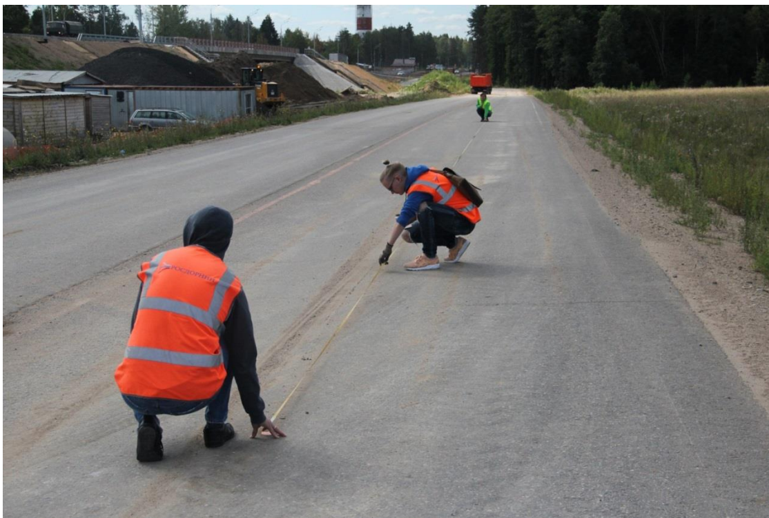
Рисунок 9 — Процесс разметки траекторий для движения георадарных установок
