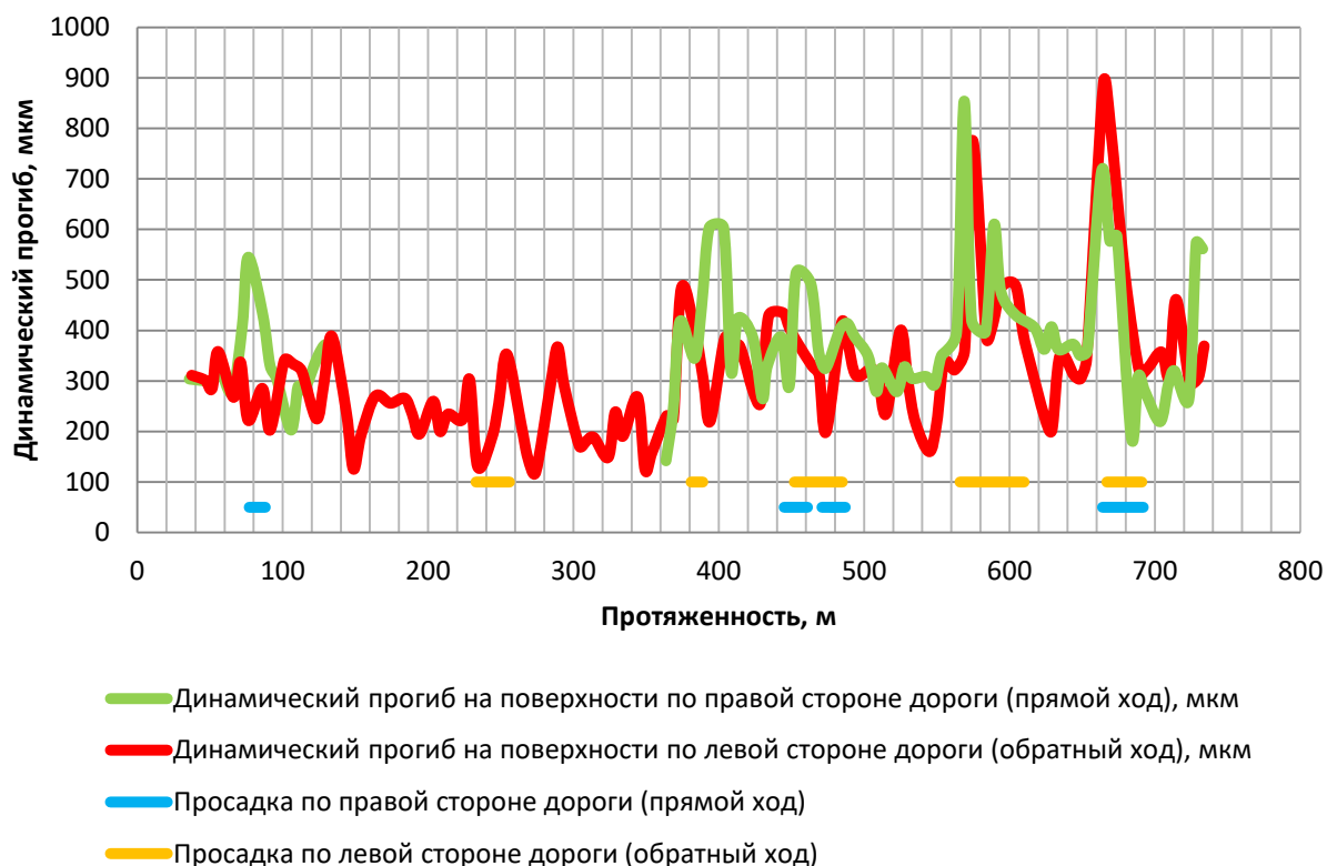
Рисунок 15 — График зависимости изменения динамического прогиба (2019 г.) от местоположения просадок по результатам георадарного обследования
