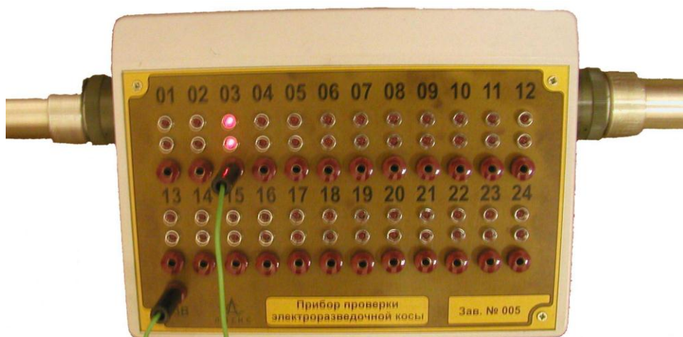
Рис. 3. Прибор проверки электроразведочной косы.
