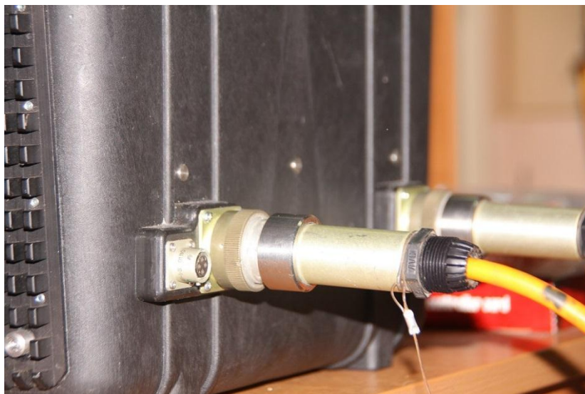
Рис. 8. Подключение разъемов косы к Регистратору.
