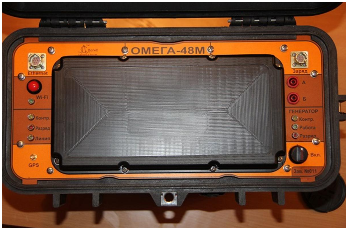
Рис. 9. Лицевая панель Регистратора «ОМЕГА-48М»
