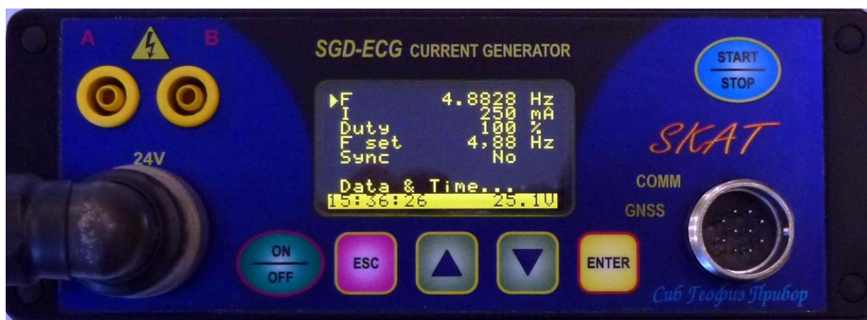
Рис. 1. Генератор тока электроразведочный SGD-EGC200 «SKAT II»
