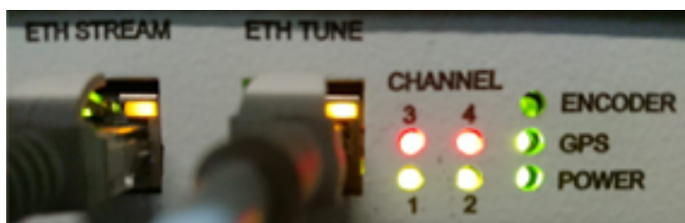
Рисунок 3. Светодиодная сигнализация работоспособности основных узлов.
