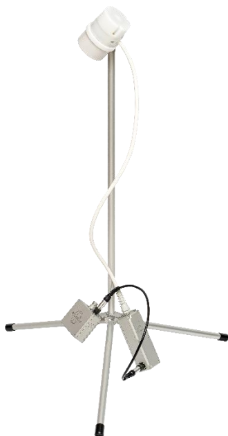
Рисунок 23 – Датчик, аналоговый и цифровой блоки, закреплённые на немагнитной треноге
