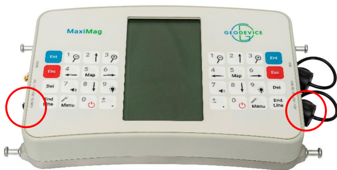
Рисунок 16 Разъёмы CAN FD+12V для подключения кабеля датчик-пульт на корпусе ПУ
