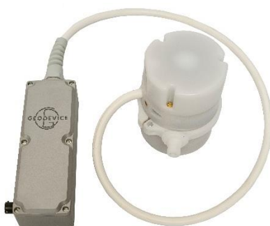
Рисунок 9 Цезиевый датчик с кронштейном на гибком кабеле
