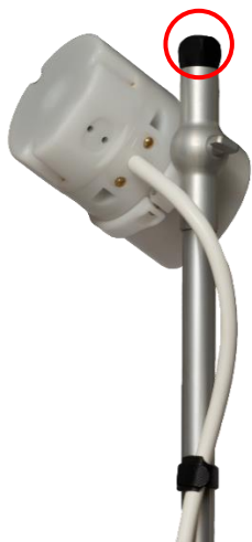
Рисунок 27 – Место крепления ГНСС антенны
