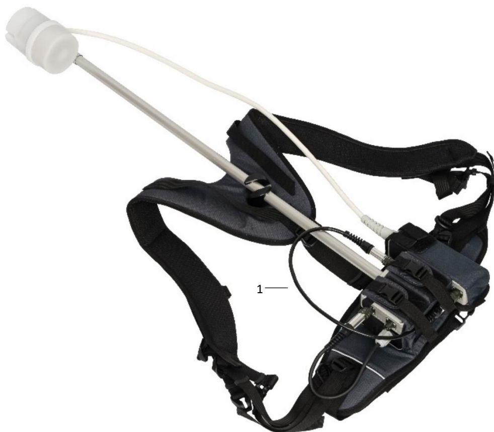
Рисунок 12 Магнитометр QuantumMag в рюкзаке-разгрузке
