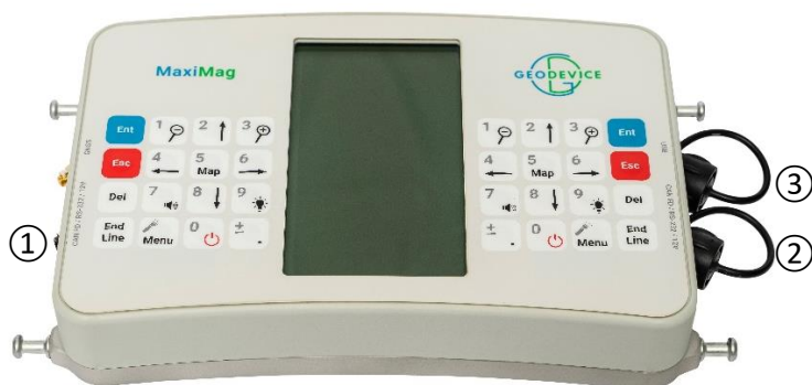
Рисунок 67 Разъём для подключения аккумулятора на корпусе пульта MaxiMag
