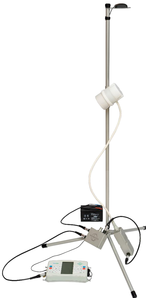
Рисунок 29 – MBC с подключенным ПУ и ГНСС антенной на треноге
