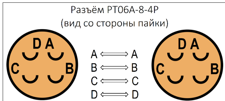
Рисунок 82 – Схема распайки кабеля связи датчик-пульт
