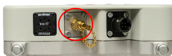
Рисунок 18 Разъём SMA для подключения внешней антенны
