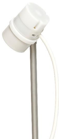
Рисунок 10 Цезиевый датчик, закреплённый на штанге
