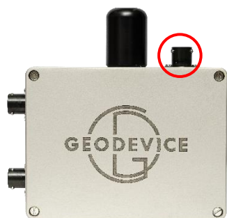
Рисунок 20 – Разъём для подключения кабеля датчика на корпусе ПУ
