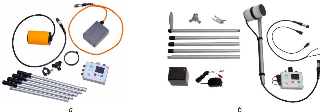
Рисунок 81 Состав пешеходного оверхаузеровского магнитометра SmartMag а – комплектация до 2023 г, б – комплектация после 2022 г
