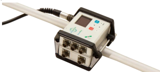
Рисунок 35 Сборка датчика OVHmag и SmartMag в магнитометр-градиентометр
