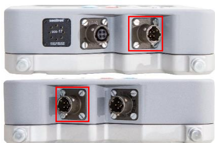
Рисунок 114 Разъем для подключения аккумулятора на корпусе пульта MaxiMag
