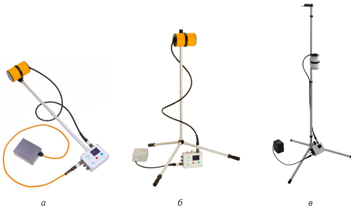
Рисунок 5 Оверхаузеровский магнитометр SmartMag а – пешеходный вариант, б – вариационная станция (до 2023 г), в – вариационная станция (модификация после 2022 г)
