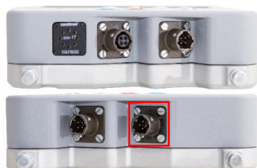
Рисунок 117 Разъем для подключения кабеля USB на корпусе ПУ MaxiMag
