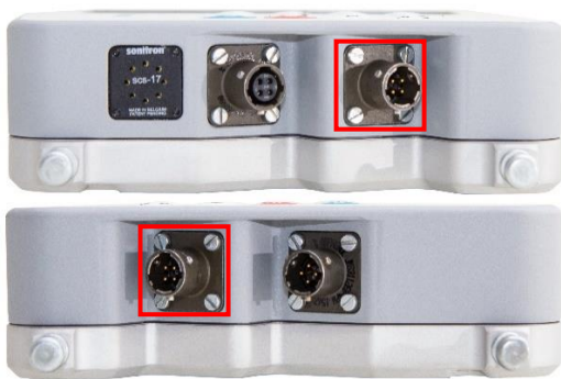
Рисунок 32 Разъёмы CAN FD+12V для подключения кабеля датчик-пульт на корпусе ПУ
