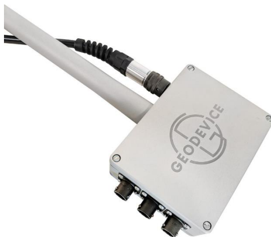
Рисунок 16 Блок электроники OVHmag на немагнитной штанге
