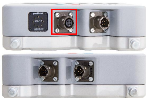
Рисунок 25 Разъем GNSS для подключения кабеля Garmin-пульт на корпусе ПУ MaxiMag
