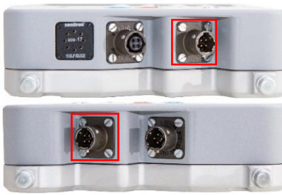
Рисунок 120 Разъем для подключения кабеля CAN FD или RS-232 на корпусе ПУ MaxiMag
