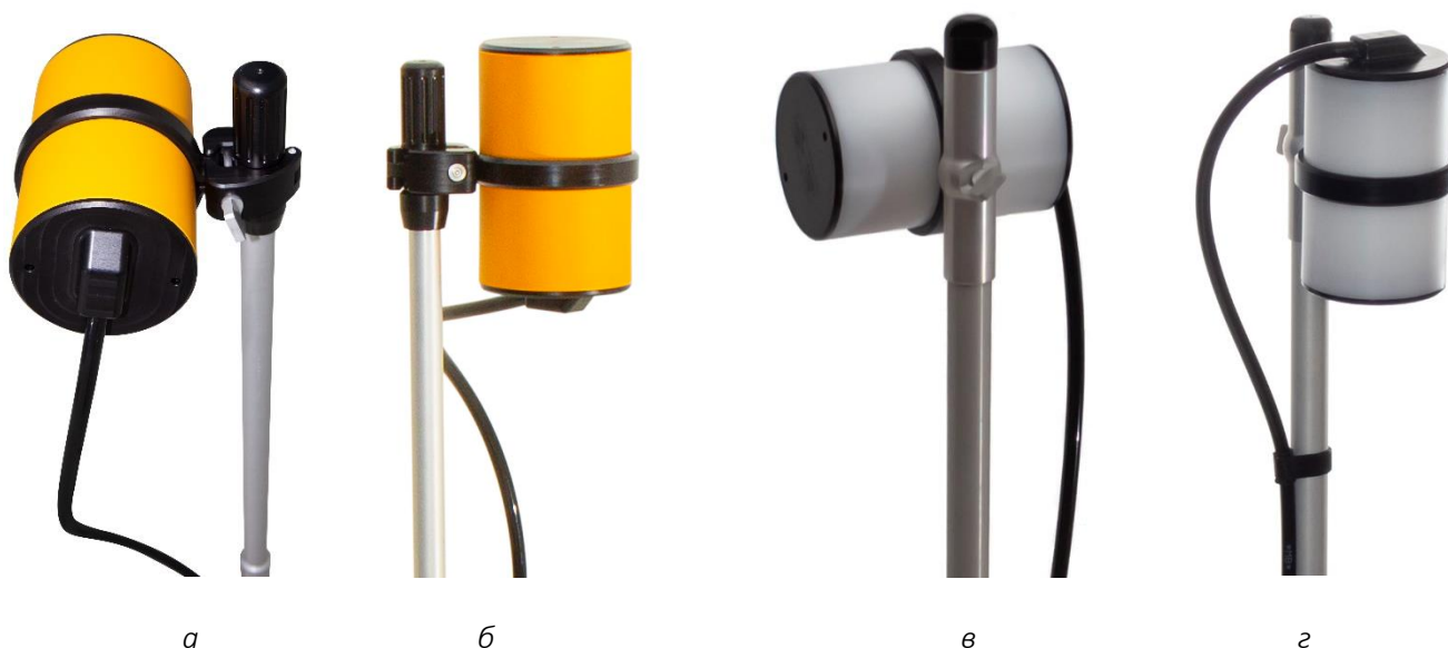
Рисунок 85 Оверхаузеровский датчик, закреплённый на немагнитной треноге а, б – модификация до 2023 г; в, г – модификация после 2022 г
