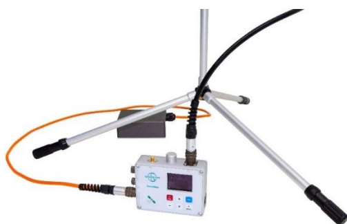
Рисунок 90 ПУ с подключенным Оверхаузеровским датчиком и аккумулятором а – модификация до 2023 г; б – модификация после 2022 г
