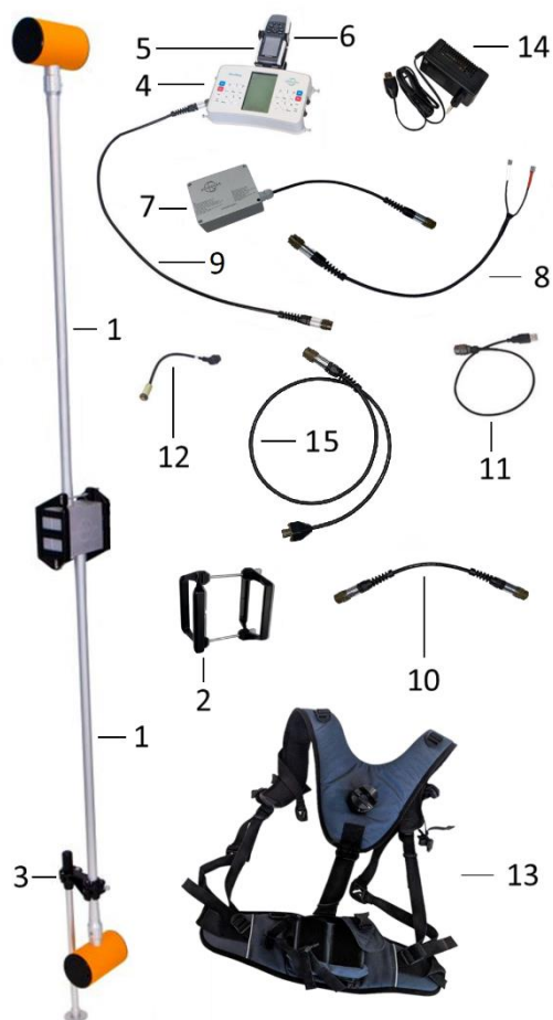
Рисунок 3 – Состав магнитометра OVNmag на штанге в режиме градиентометра
