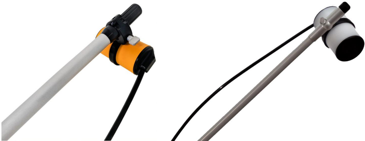
Рисунок 15 Оверхаузеровский датчик, закреплённый на штанге а – модификация до 2023 года; а – модификация после 2022 года;
