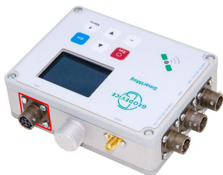
Рисунок 86 Разъём для подключения кабеля Оверхаузеровского датчика на корпусе ПУ
